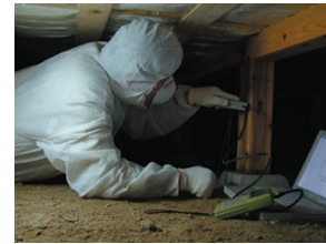
●床下での含水率測定風景
